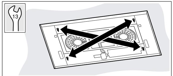
14 Извлеките крепления прибора из отверстий в виде замочной скважины.
