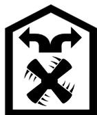
Zassane powietrze jest oczyszczane przez filtry przeciwłuszczowe oraz filtr zapachów i z powrotem kierowane do kuchni.
